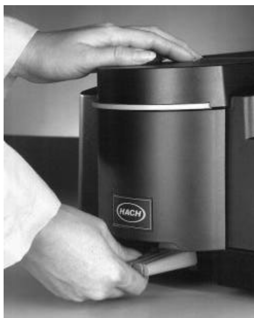
图 7 开启模块锁和取出模块
